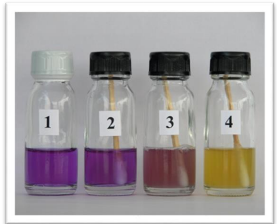
8. ตั้งทิ้งไว้ที่อุณหภูมิห้อง (25-40°C) เป็นเวลา 24-48 ชั่วโมง แล้วตรวจสอบผลโดยเทียบกับแผ่นเทียบสี SI Medium (อ 13)
