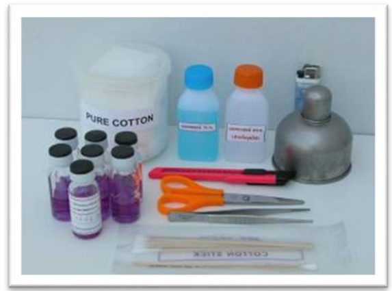
2. อุปกรณ์สำหรับใช้ในการตรวจสอบด้วยอาหารตรวจเชื้อโคลิฟอร์มแบคทีเรีย SI Medium (อ 13)
